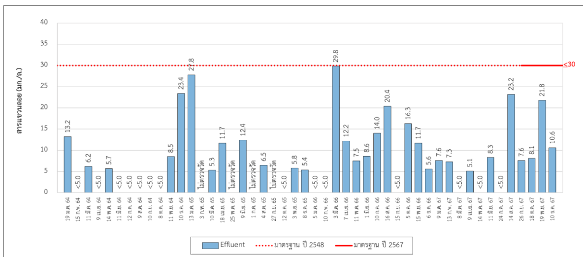
รูปที่ 3-3 เปรียบเทียบคุณภาพน้ำหลังจากจากระบบบำบัดน้ำเสีย ระหว่างปี พ.ศ. 2564-2567
